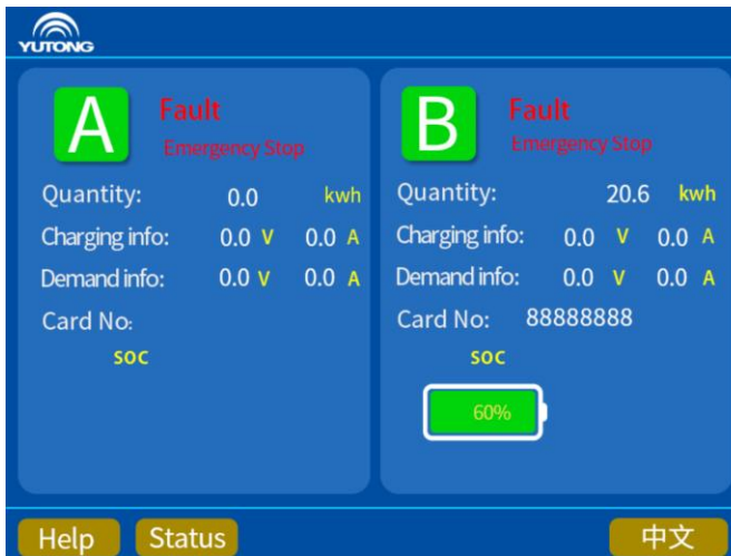
Figure 14 Interface d'affichage d'arrêt d'urgence
